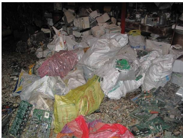
Foto 8. Aquí las placas se juntan por tamaños para alcanzar el menor volumen posible. Las placas amarradas (atrás) permiten un manejo más fácil.
