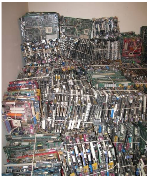
Foto 8. Aquí las placas se juntan por tamaños para alcanzar el menor volumen posible. Las placas amarradas (atrás) permiten un manejo más fácil.
